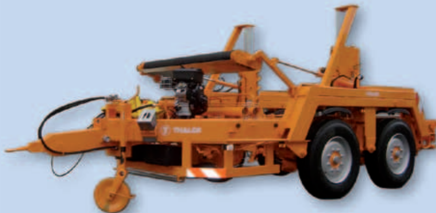
TTA 1286 abgebildet mit doppeltem Gummilwalzenantrieb
